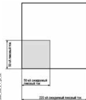
Рис.3. Ограничение электродинамических сил прямо пропорционально квадрату значения тока.
