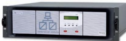
Установленный в систему **PHASYS ELITE**, модуль мониторинга и управления **PHASYS STAR** обрабатывает информацию, поступающую от преобразователей, работающих в параллель. 32-символьный ЖК-дисплей и 4 светодиодных индикатора обеспечивают надежный и легкий доступ ко всей информации.
