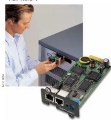
Этот интерфейс позволяет осуществлять мониторинг, программирование и управление ИБП либо при помощи обычного Web-браузера, либо при помощи NMS (Network Management Station) по протоколу SNMP. NET VISION обеспечивает свертку программ удаленного сервера или клиентских рабочих станций, подключенных к вычислительной сети.
