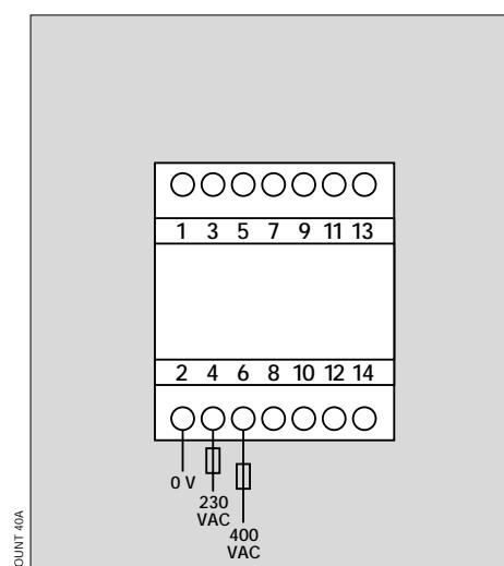
Instalar una protección por fusible de 500 mA.
