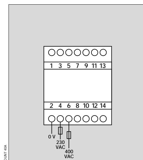
Instalar uma protecção por fusível de 500 mA.
