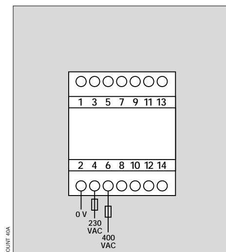
Installare una protezione con fusibile da 500 mA.
