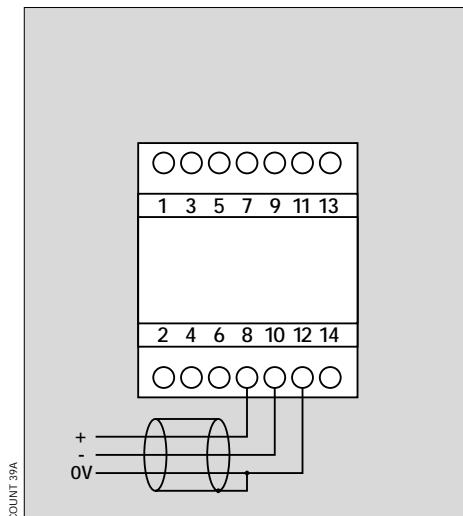
Il Countis Ci si può collegare a una rete di comunicazione RS485 con protocollo JBUS/MODBUS®. In una configurazione standard, è possibile collegare 31 Countis Ci su una distanza massima di 1500 metri a 9600 baud. Se la distanza o il numero mas-
