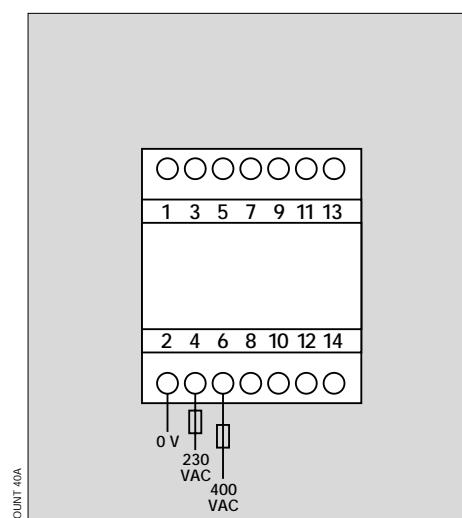
Installeer een bescherming per zekering van 500 mA.
