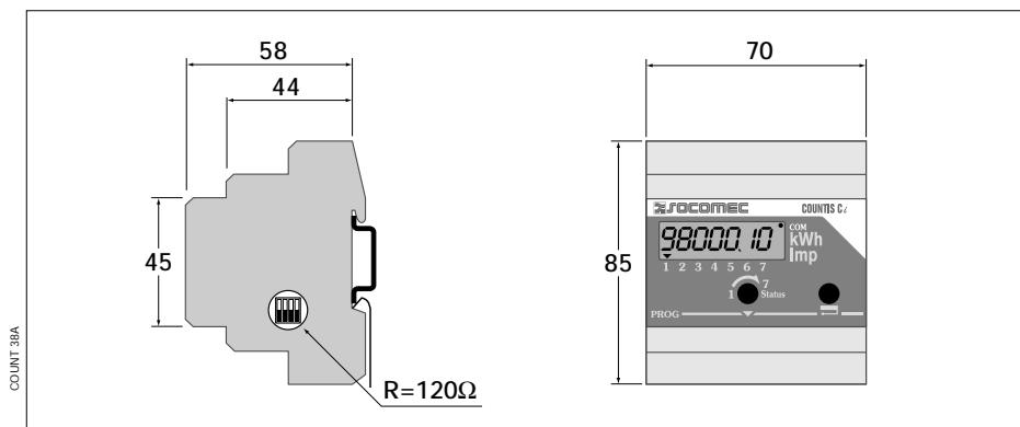
Raccordement à partir de bornes à cages de 0,5 à 6 mm<sup>2</sup>
