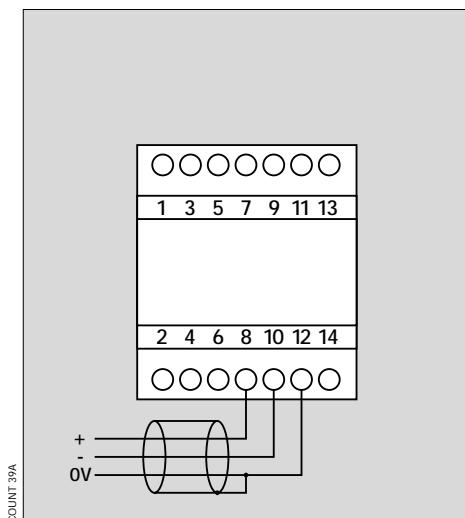
El Countis Ci puede ser conectado a una red de comunicación RS485, en protocolo JBUS/MODBUS®. En una configuración estándar, es posible conectar 31 Countis Ci sobre una distancia de 1500 metros a 9600 baudios. Si se sobrepasa la distancia o el
