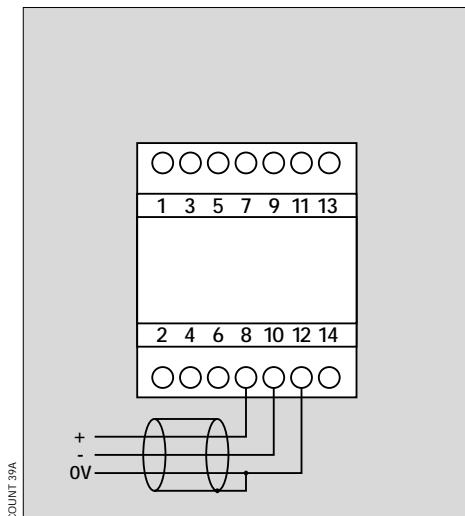
Le Countis Ci peut être raccordé à un réseau de communication RS485, en protocole JBUS/MODBUS®. Dans une configuration standard, il est possible de raccorder 31 Countis Ci sur une distance de 1500 mètres à 9600 bauds. Si la distance ou le
